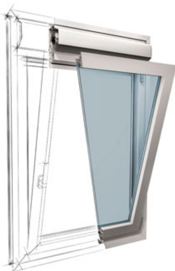
Profilati studiati principalmente per soluzioni in battuta esterna con possibilità di telaio con battuta interna. Possibilità di coibentazione del cassetto interno. Cerniere con copertura in nylon colore nero. Possibilità di movimentazione del telo tapparella tramite avvolgitore incassato, arganello o motore elettrico. Possibilità di coibentazione del cassetto interno.
